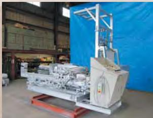
ガス化熔融炉開閉機
