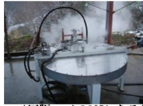
(図版 cap) 80℃になるとシャッターが自動開閉する
